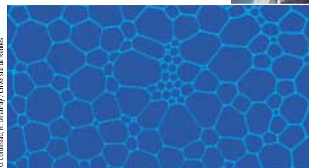
1. UNE MOUSSE à deux dimensions ( ci-dessus ) s'obtient en pressant une mousse entre deux plaques jusqu'à obtenir une couche de bulles. Il y a peu d'eau dans la mousse, de sorte que les bulles sont polygonales. Leur agencement respecte les règles de Plateau : les arêtes se croisent avec des angles de 120 degrés. Dans une mousse tridimensionnelle ( ci-contre ), les angles entre arêtes sont d'environ 109,5 degrés.
